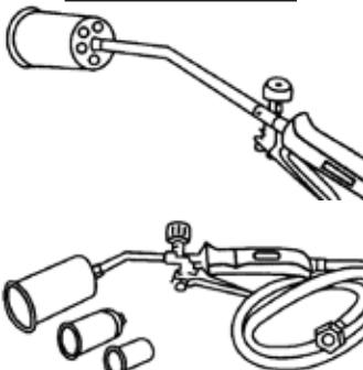
Plamenik za grijanje i lemljenje je visoke kvalitete s atestom te garantira jednostavnost primjene, sigurnost i dobre rezultate. Sa propanom se postižu bolji rezultati ali se može upotrebljavati i butan. Spoj s bocom izvesti pomoću atestirane gumene cijevi u skladu s lokalnim propisima. Boca mora biti opremljena regulatorom tlaka.
