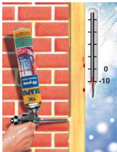
TEKAPUR PU - Pištoljska zimska pjena je jednokomponentna poliuretanska pjena namijenjena uporabi s montažnim pištoljima. Stvrdnjavanje uz pomoć vlage iz zraka.
